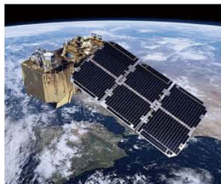
哨兵2号（Sentinel-2）卫星光学成像任务是基于2个相同卫星构建的星座：2015年6月发射的哨兵2A（Sentinel-2A）卫星和哨兵2B（Sentinel-2B）卫星。虽然2颗卫星分别单独发射，但它们被放置在相隔180度的相同轨道上。
