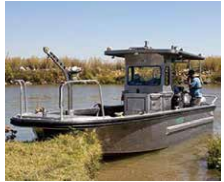
美国地质调查局（USGS）“玛丽兰·德斯泰纳号”科考船在旧金山北部河口短暂停留开展研究工作。USGS科学家Bryan Downing正在对船载实时测量系统进行校准。图片由de Ropp媒体公司Stephen de Ropp提供。如需获取更大版本图片，请查看： http://www.jpl.nasa.gov/images/earth/20160225/usgs20160225b.jpg 。
